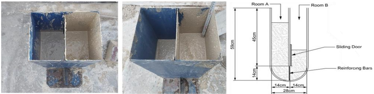
شکل ۸- شماتیک و تصاویری از آزمایش جعبه U بر روی بتن خودتراکم [۲۷]
