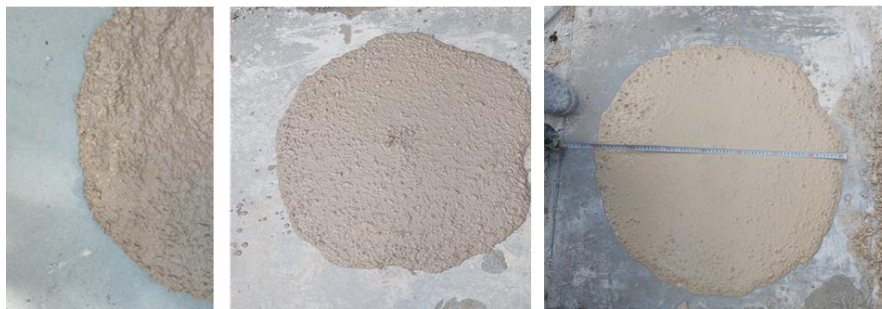
شکل ۴- شماتیک و تصویری از آزمایش جریان اسلامپ و اندازه گیری قطر پهن شدگی [۲۷]
