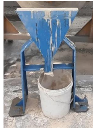
شکل ۵- شماتیک و تصویری از آزمایش قیف V بتن خودتراکم [۲۷]
