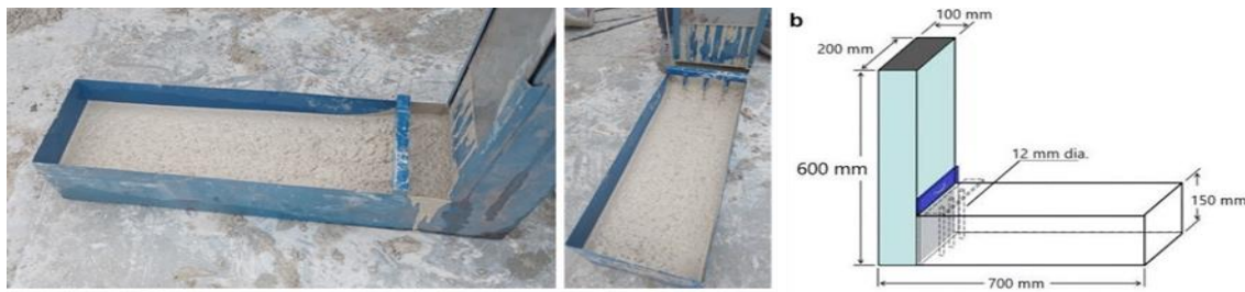
شکل ۷- شماتیک و تصویری از آزمایش جعبه L بتن خودتراکم [۲۷]
