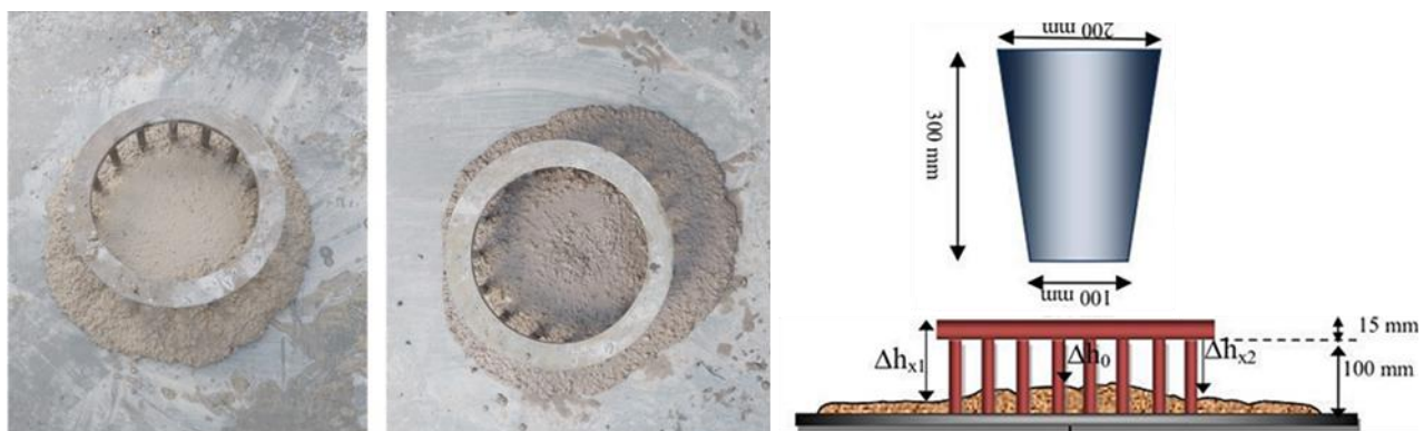
شکل ۶- شماتیک و تصاویری از آزمایش حلقه J بر روی بتن خودتراکم [۲۷]
