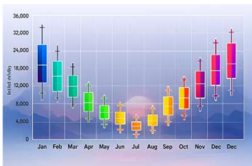
شکل ۵- نمودار کندل‌استیکی بار گرمایش ماهانه در سناریوی مواد تغییر فازدهنده (PCM)
