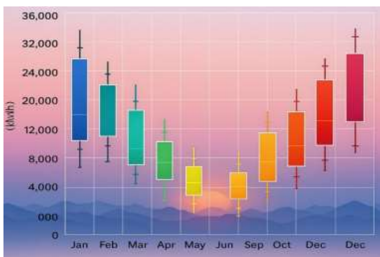
شکل ۶- نمودار کندل استیکی بار گرمایش ماهانه در سناریوی چهارم با به کارگیری عایق حرارتی نوین در پوسته خارجی ساختمان
