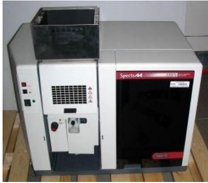
شکل (۶) دستگاه جذب اتمی برای تعیین غلظت فلزات سنگین
