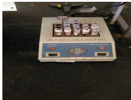
شکل (۴) دستگاه راکتور جهت انجام آزمایش COD
