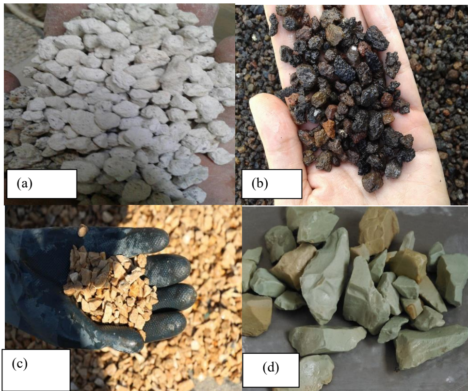
شکل (۳) جاذب‌های مصرفی: (a) پومیس، (b) اسکریا، (c) تراورتن و (d) زئولیت
