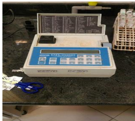
شکل (۵) دستگاه اسپکتوفتومتر برای محاسبه COD
