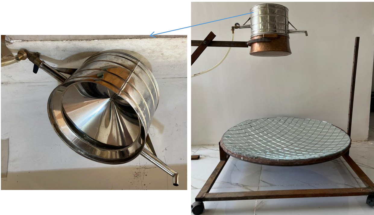
شکل ۳- نمایی از دستگاه تصفیه آب ساخته شده شامل متمرکز کننده، جاذب، سیستم تقطیر، بازوهای نگهدارنده، پایه ها و اتصالات (شکل سمت راست) و نمایی از دستگاه تقطیر (شکل سمت چپ)
