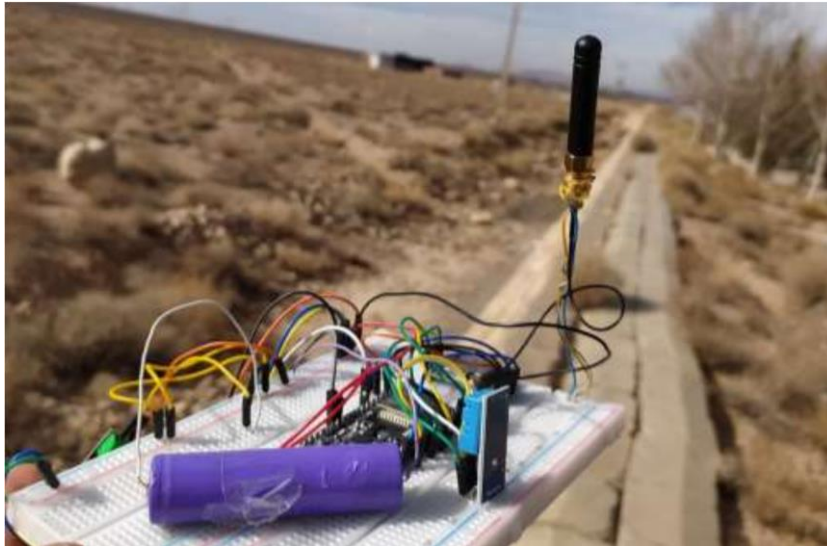
شکل ۱: نمونه اولیه سیستم پایش محیطی پیاده‌سازی شده بر روی بردبرد
